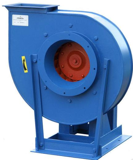
Вентиляторы высокого давления ВР-132-30 предназначены для перемещения невзрывоопасных и неагрессивных газозвушных смесей с температурой не более 80С° и запыленностью не более 1 г/м3, не содержащего липких и волокнистых веществ. Температура окружающего воздуха от минуса 40С° до плюса 40С°, относительной влажности 80%.
